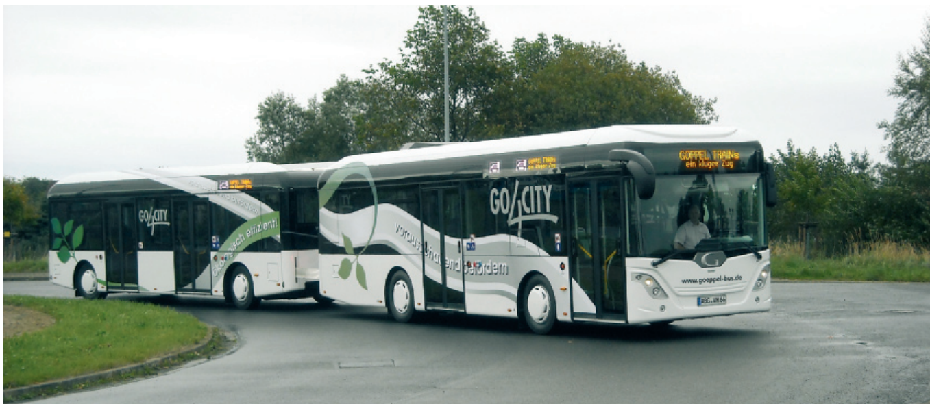
Dieser Buszug, bestehend aus einem »go4city 10« mit Anhänger »go4city t« dient als Vorführzug der Firma Göppel. Die Besonderheit hierbei: erstmals wurde ein 2,55 m breiter Midibus als Zugfahrzeug gebaut. Mit einer Zuglänge von 21,5 Metern ist dieses Göppel-Eigenprodukt auch dort einsetzbar, wo außerhalb der Verkehrsspitzen nur ein großer Midibus benötigt wird.
